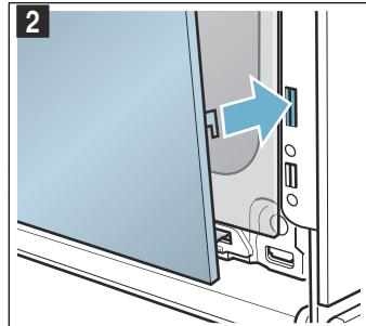
3. Нажмите на переднее стекло так, чтобы оно зафиксировалось со слышимым щелчком (рис. 3).
