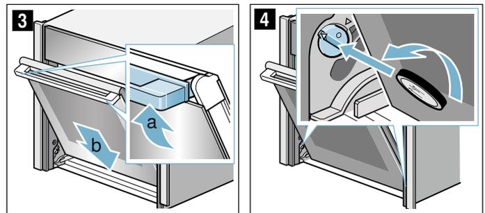
Левый фиксатор: против часовой стрелки
