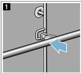
2. Передвиньте стержень назад **a** и навесьте его движением вниз **b** на штырьке **c** (рис. **2**).
