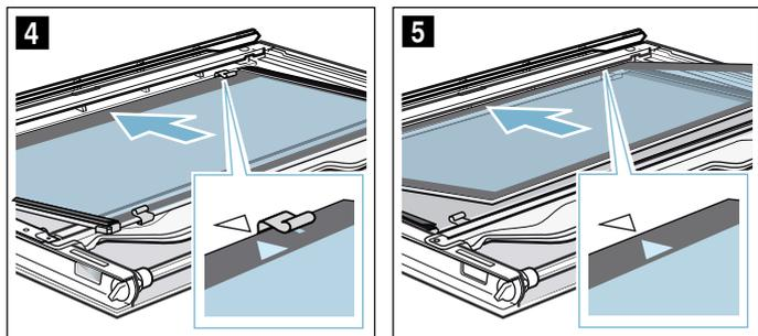
5. Отожмите внутреннее стекло вниз на участке **b**, вставьте держатель **c** под наклоном и прижмите так, чтобы он зафиксировался (рис. 6). Держатель установлен (рис. 7).
