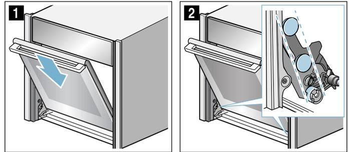
2. Слегка поверните ручку дверцы вверх **a** (рис. 3). Дверца полностью опустится вниз **b** (рис. 3).
