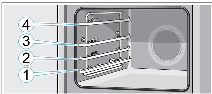
Выдвинутые наполовину принадлежности не опрокидываются. С помощью выдвижных направляющих можно выдвигать принадлежности.
